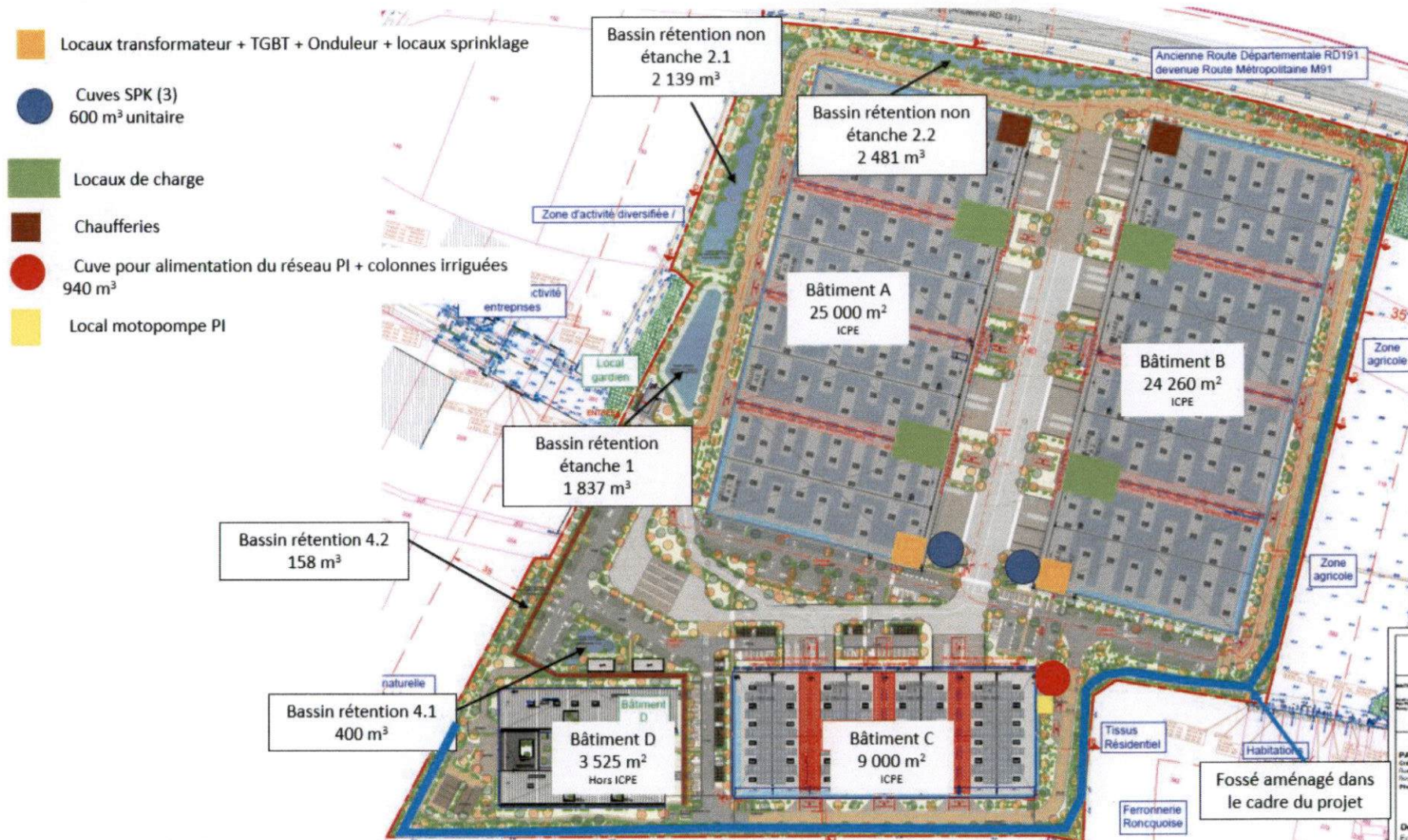
Figure 4 : Localisation des principales installations du projet
